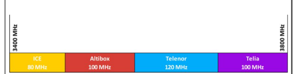
Figur 2: Innplassering i 3,6 GHz-båndet
